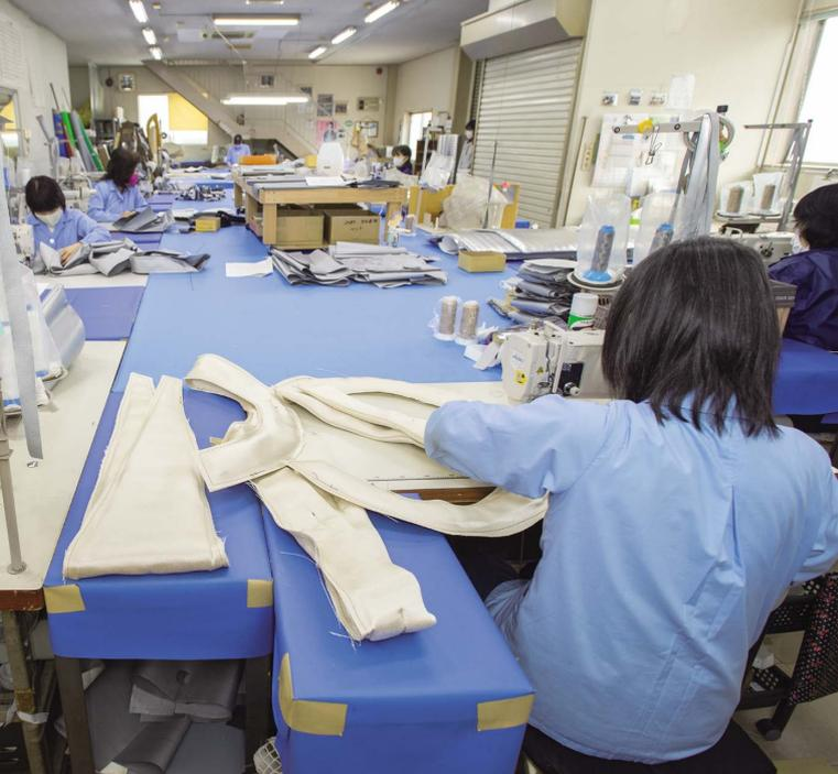
下九沢工場内の写真。左写真手前は熱交換器のダクトに使うファインジャケットの製作風景。工業用ミシンを使いこなすには相応のキャリアが必要で、裁断・縫製のプロが揃った現場では緻密な製品が生み出されている
